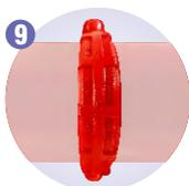
**9** União: Utilizamos uniões através de acoplamentos flexíveis com sistema ranhurado para pressões até 69bar (até  $\varnothing 12''$ ), com facilidade de alinhamento de montagem e fácil manutenção, boas tolerâncias em situações de contração/deflexão, garantindo estanquidade do sistema. União fornecidas todas em acordância com as exigências da norma NFPA-20.
