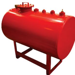
**Tanque externo:** Tanques de combustível construídos em aço carbono, cobrindo a autonomia de volume de incêndio dos projetos NFPA-20 (Norma Internacional) - NBR 10897 (Sprinklers) - NBR 13714 (Hidrantes) - NBR 16704, com respiro para segurança do projeto, incluindo também indicador de nível visual e projetos especiais com medidor de nível eletrônico para acionamento de alarme
