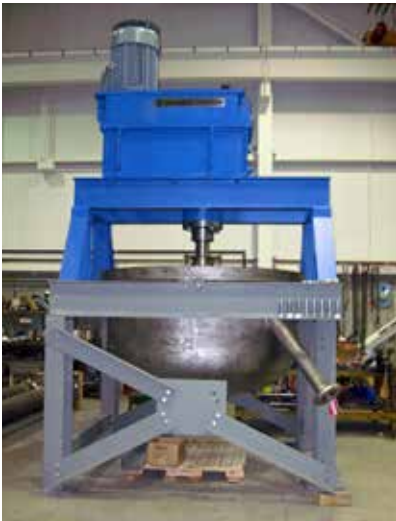
Solução completa composta por agitador; tanque para para desnitrificação de urânio.
