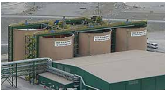
Agitadores equipados com 150 HP operando em tanques de polpa concentrada de zinco e cobre.
